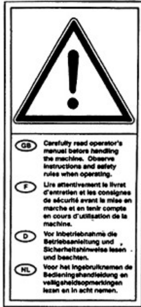
Hình 8 – Ví dụ về ký hiệu an toàn của “sách hướng dẫn cho người vận hành đọc” bằng bốn thứ tiếng để sử dụng trên sản phẩm có các ký hiệu an toàn không lời
