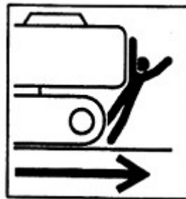
Hình D.21 - Ví dụ về hình ảnh sử dụng mũi tên để biểu thị chiều chuyển động của toàn máy
